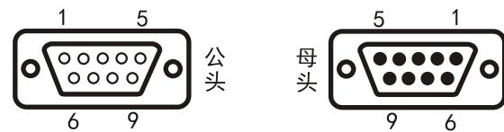
针脚1, 4, 6, 7, 8无连接，VCC供电电压范围：3V~6V
